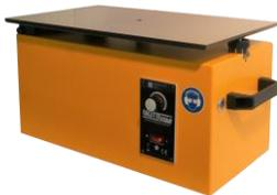
Maschine mit stufenlosem Mittelfrequenzmotor
